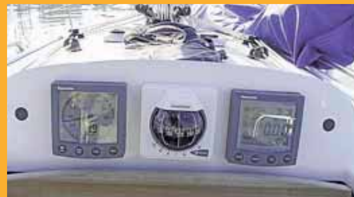
La calandatura sopra al tambuccio funge da pratico porta strumenti. A destra il gavone esterno con il portabombole
