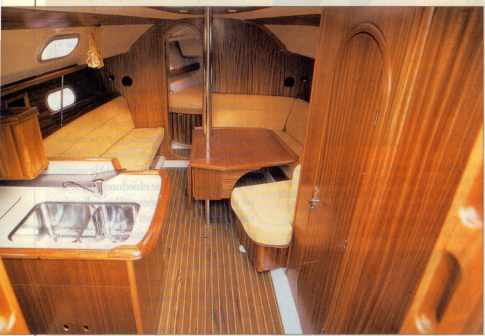
Sopra, una panoramica del quadrato che mette in evidenza la sua estensione in lunghezza. Il passo, che è la distanza tra le due paratie che lo contengono, è infatti di ben 370 cm.
