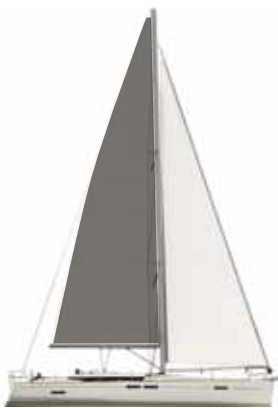
Battened mainsail / Grande voile lattée / Durchgelattetes Großsegel / Mayor con sables forzados / Randa steccata
