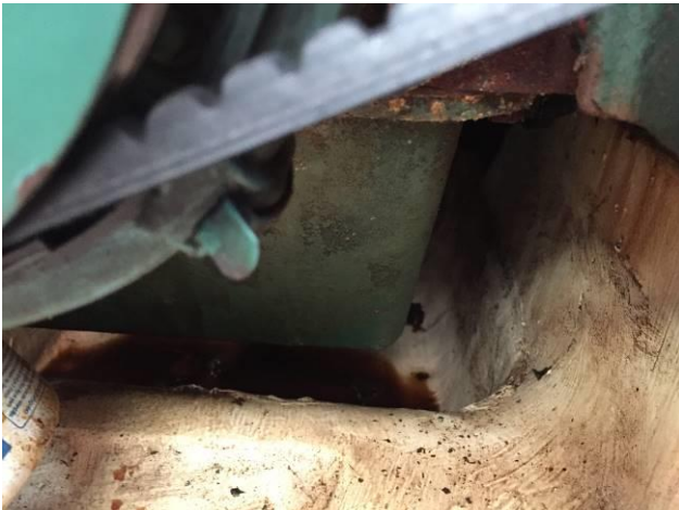
Trafilamenti di sostanze oleose nel vano motore
