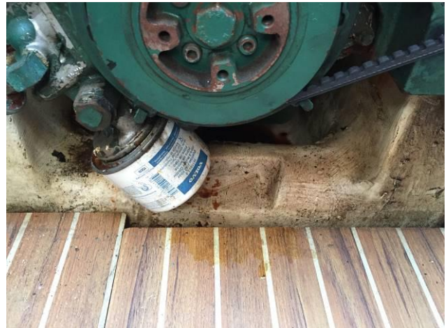
Trafilamenti di sostanze oleose nel vano motore
