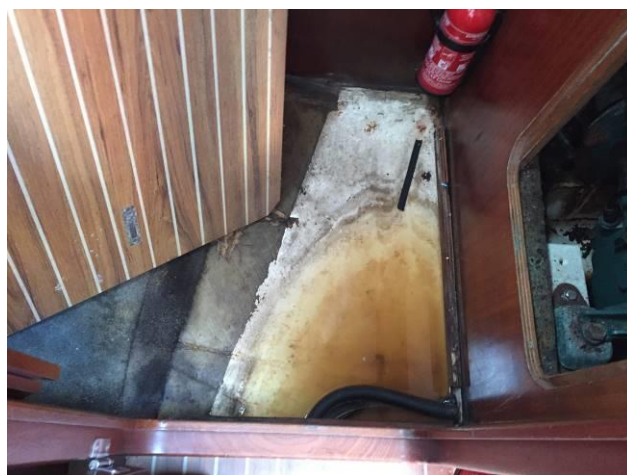
Presenza di acqua in sentina
