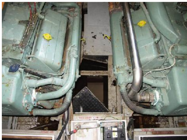
Foto 52 – Apparato motore al centro: è visibile l'acqua sul fondo
