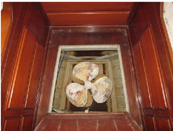
Foto 45 – Cabina armatore: botola con vano eliche di rispetto
