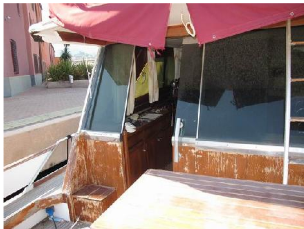
Foto 8 – Paratia poppiera della sovrastruttura con porta di accesso alla dinette
