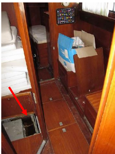
Foto 37 – Corridoio. La freccia indica il livello dell'acqua nella botola
