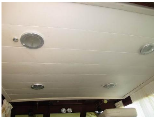
Foto 24 – Rivestimento del cielo del salone in pannelli bianchi
