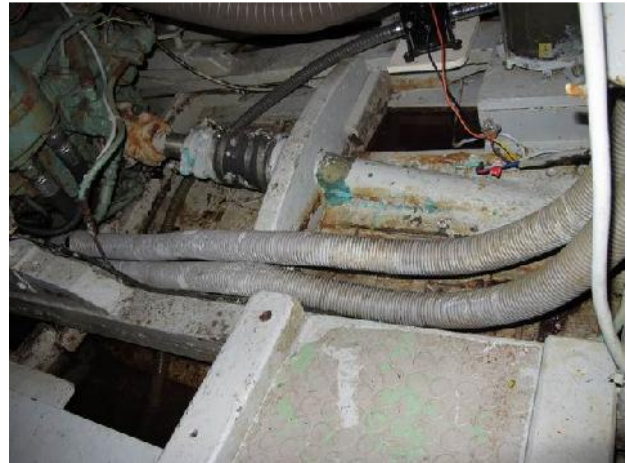
Foto 64 – Astuccio dell'asse dell'elica del motore di dritta visto dal locale tecnico di poppa
