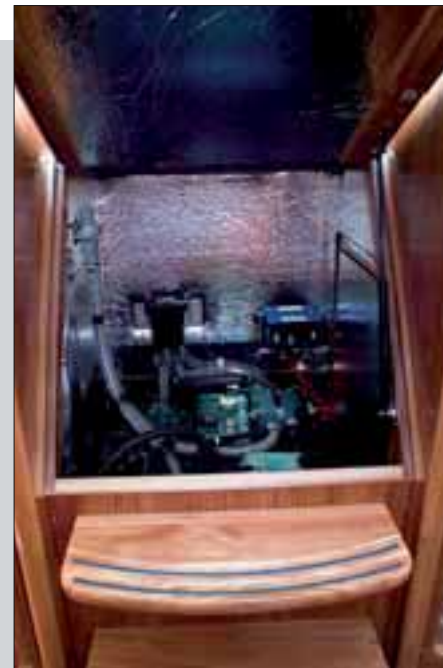
Il Bavaria 37 è motorizzato con un Volvo Penta da 29 hp. Sopra, il vano motore sotto la scaletta d'accesso in quadrato
