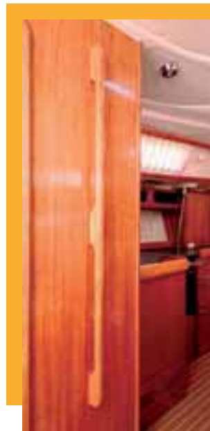
I tientibene in dinette: a sinistra quello montato sulla paratia del bagno; sopra quello ricavato nell'angolo del tavolo da carteggio
