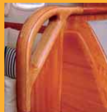
I tientibene in dinette: a sinistra quello montato sulla paratia del bagno; sopra quello ricavato nell'angolo del tavolo da carteggio
