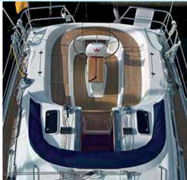
Sopra, il pozzetto: qui si nota bene quanto la struttura centrale della colonnina e del tavolo sia invadente e sproporzionata. A fianco, il tavolino aperto lascia vedere il portello della ghiacciaia
