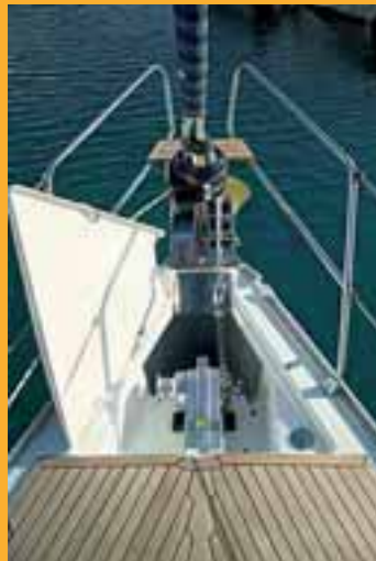
Sotto, il gavone dell'ancora con il salpancore sotto il piano di calpestio e il doppio musone in acciaio
