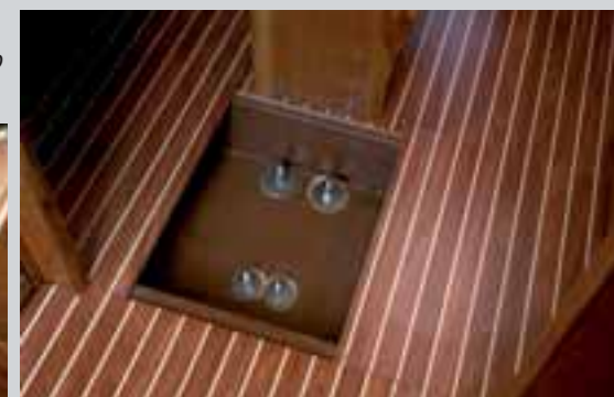
A sinistra, un particolare indovinato del cantiere per la sistemazione delle bottiglie in quadrato; sotto, i prigionieri che fissano il bulbo alla chiglia
