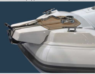
Musone di prua con verricello salpaancora elettrico
