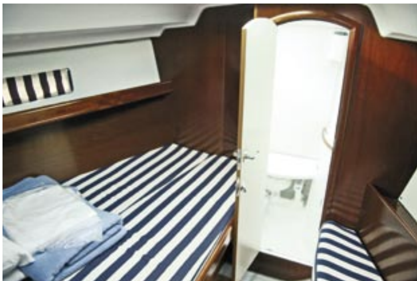
Die Vorschiffskoje wurde seitlich an Backbord eingebaut und bietet in dieser Position eine komfortable Liegefläche. Gleichzeitig verbleibt ein ausreichend breiter Durchgang in die vordere Nasszelle und viel Stauraum an Steuerbord
