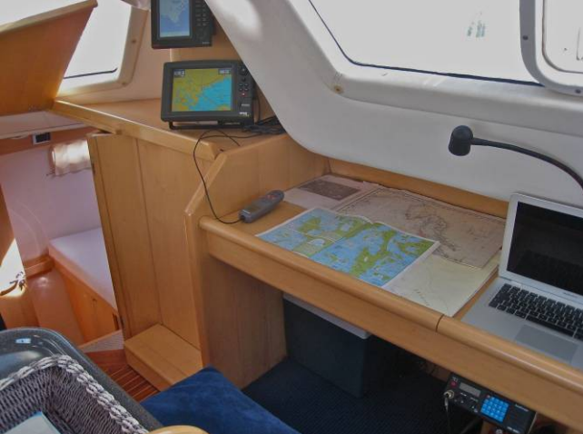
Posto di carteggio e pilotaggio con vista frontale e con i comandi del pilota automatico, radio VHF, GPS e radar
