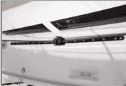
Sopra, la rotaia del carrello del mastro; sotto, due superfici inclinate fungono da punta piedi per il timoniere
