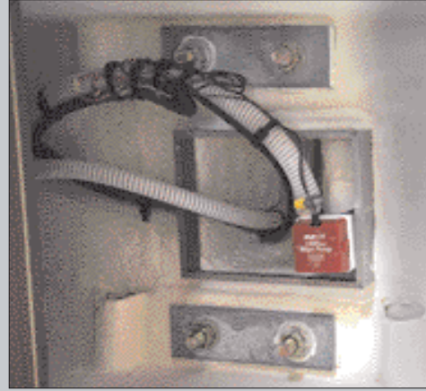
Sotto, il motore Yanmar da 54 hp; a destra, la sartia bassa ancorata a un rinforzo strutturale del controstampo
