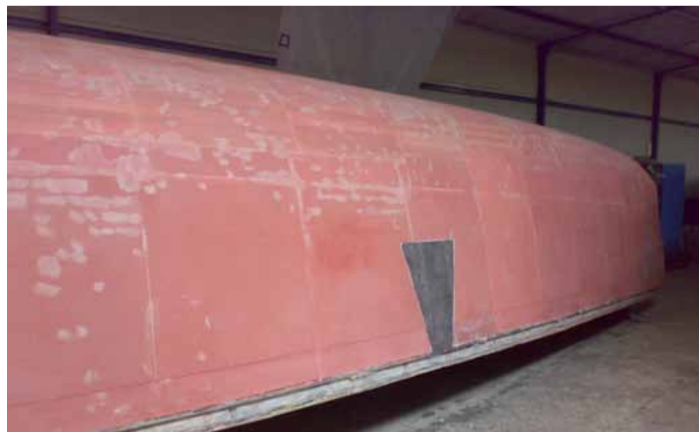
La schiuma del sandwich: in evidenza le lande in solid
