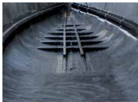
Alcuni dettagli della laminazione in carbonio.
