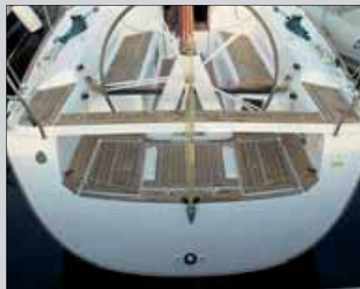
In alto, il trasto della randa con la regolazione di fino. Sopra, il settore del timone ben ispezionabile. A sinistra, la poppa chiusa dalla seduta del timoniere
