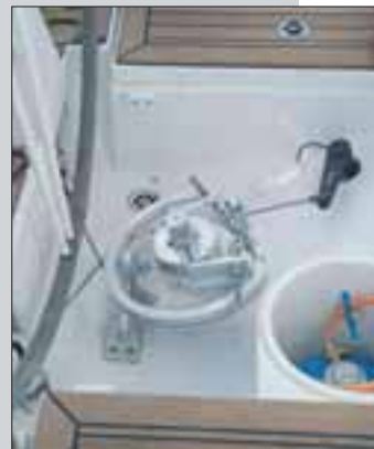
In alto, il trasto della randa con la regolazione di fino. Sopra, il settore del timone ben ispezionabile. A sinistra, la poppa chiusa dalla seduta del timoniere
