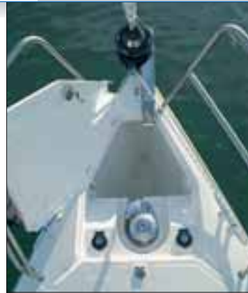
A sinistra, il profondo pozzo dell'ancora con il verricello a comandi a piede. Sotto, l'ampio passavanti con la rotaia del genoa a filo della tuga
