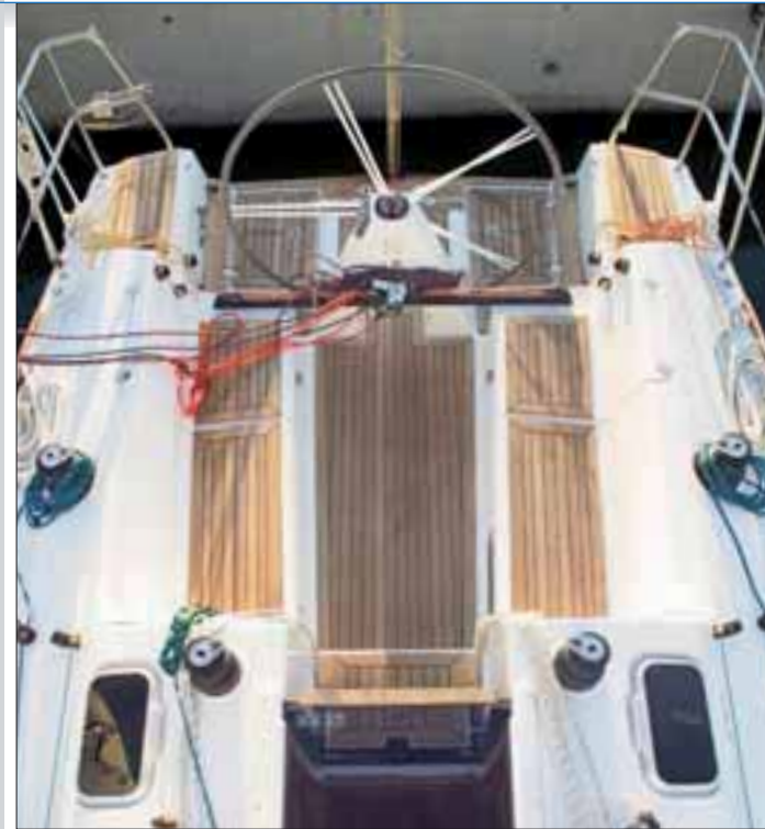
Una visione d'insieme del pozzetto. Si nota la poppa aperta; può essere chiusa da una panca che funge da seduta per il timoniere. Il paramare è alto e offre una buona protezione
