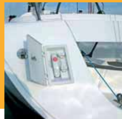
I rinvii (a sinistra) per la regolazione del trasto randa e dello strallo di poppa. Il vano dedicato alla doccia esterna (sotto) con acqua calda e fredda
