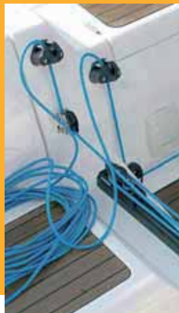
I rinvii (a sinistra) per la regolazione del trasto randa e dello strallo di poppa. Il vano dedicato alla doccia esterna (sotto) con acqua calda e fredda
