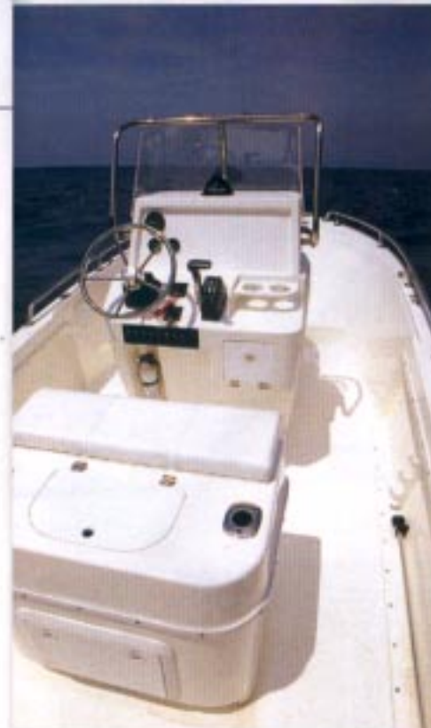
A sinistra, il passavomo tra la consolle di guida e la murata misura 51 centimetri. A destra, la doppia seduta a prua.
