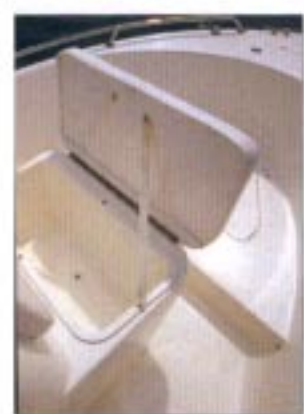
Inglottita nella struttura della consolle di guida si trova una generosa seduta per due persone. Il divanetto, sotto al quale è stato ricavato lo spazio per una ghiacciaia, è largo 80 centimetri e profondo 42.
