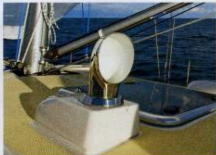
Wiederentdeckt. Der Salon wird über verchromte Doradelüfter ventiliert
