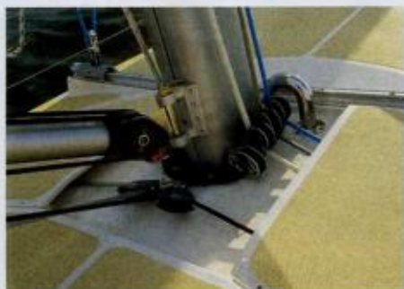
Versteckt. Fallen in Schächten. Rutschfeste Flächen werden farblich abgesetzt
