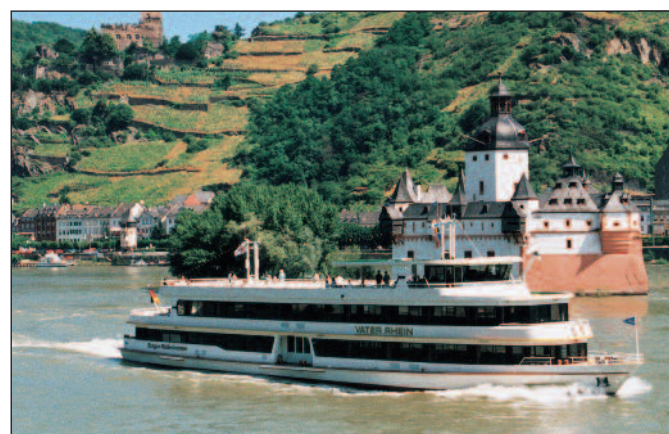
Passenger vessel, 2 x SRP 170 (285 kW each) Shipyard: Schiffswerft Lux, Germany Owner: Bingen-Rüdesheimer Fähr- und Schifffahrtsgesellschaft, Germany
