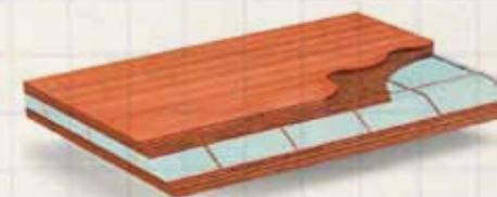
(figura 1) Esempio di pannello con coibentazione antirumore inserita in un sandwich di legno marino
