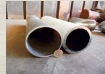
figura 1: Tubazioni da 3 Pollici in Inox e Acciaio Navale: Notare spessore diverso a SX tubo acciaio Inox a DX tubo in Acciaio Navale
