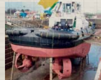
Rimorchiatore con trasmissione Azimutale
