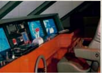
Plancia da "Yacht" con vetrature coperte dagli strumenti e inclinate al contrario. Spesso anche posizionata lontana dalla prua.
