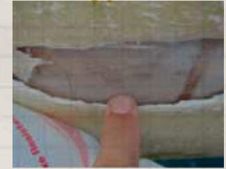
Delaminazione di uno scafo in vetroresina.
