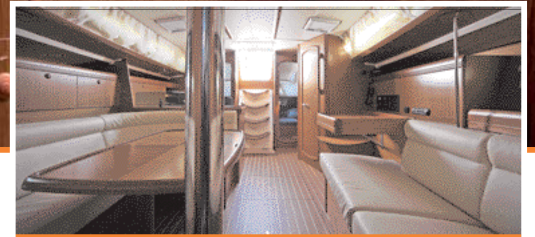
La cucina, ben arredata e funzionale, si sviluppa sulla dritta; sotto, il quadrato, che rivela buoni volumi, è dotato di due divani contrapposti utilizzabili entrambi per i pasti grazie a un dispositivo che consente l'allungamento del tavolo per mezzo di staffe
