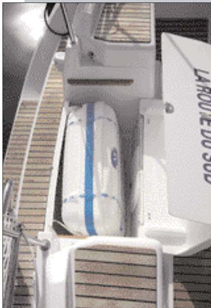
Sopra, ottima la posizione della zattera sotto la schiena d'asino a poppa; sotto, i passacavi chiusi sono molto solidi
