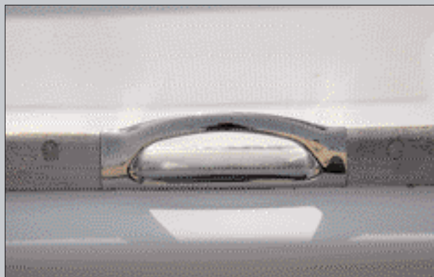
Sopra, ottima la posizione della zattera sotto la schiena d'asino a poppa; sotto, i passacavi chiusi sono molto solidi
