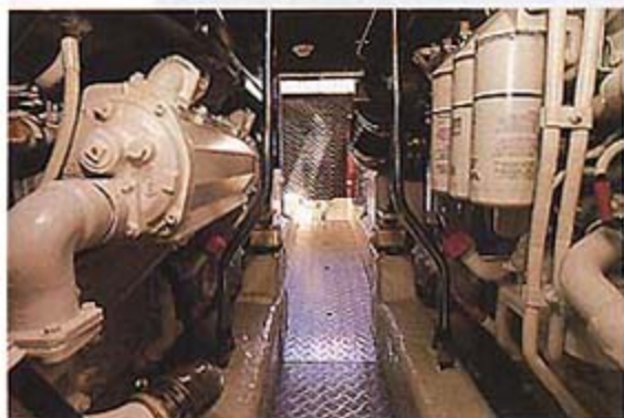
I due Volvo Penta D12 hanno una cilindrata complessiva di oltre 24 litri.
