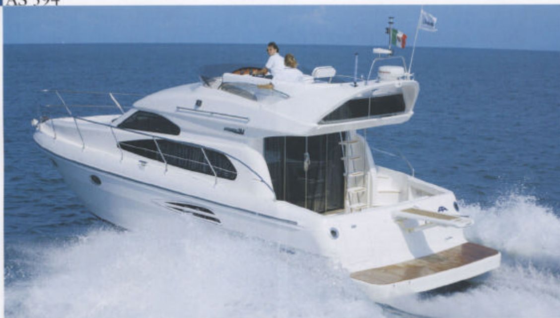
Sopra, l'AS 394, spinto da 740 cavalli è in grado sfiorare con agio 30 nodi. La generosa riserva di carburante, 950 litri, unita a consumi particolarmente contenuti dei nuovi motori Volvo Penta D6, garantisce una buona autonomia di navigazione.
