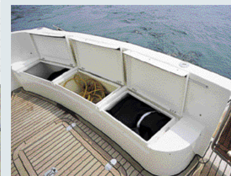
Sopra, il divano in pozzetto nasconde tre gavoni molto capienti. Sotto, la spiaggia di poppa è stata recentemente ampliata.
