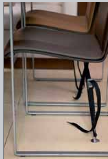
Sopra, il sistema di fissaggio delle sedie in quadrato e, a destra, l'uso della ventosa per sollevare i paioli
