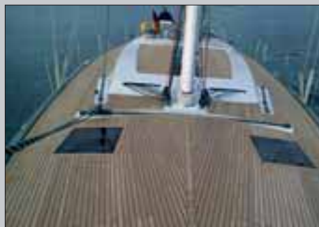
Sopra, la rotaia del fiocco autovirante. A sinistra, gli organizer e le manovre sotto traccia rinviate in pozzetto. Sotto, i due piccoli mezzi tavolini al centro del pozzetto
