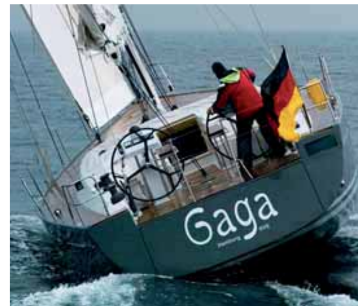
Sezioni sottili a prua, slanci quasi assenti, un baglio massimo arretrato che mantiene la sua ampiezza sino a poppa. L'Hanse 630 ha le caratteristiche per garantire navigazioni confortevoli con buone prestazioni veliche. Nelle immagini si notano la coperta pulita, il grande spazio in pozzetto e alle spalle del timoniere, le ruote in carbonio
