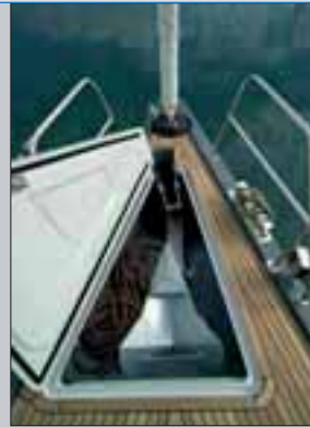
A sinistra, il gavone che contiene l'ancora che esce ribaltandosi verso l'esterno
