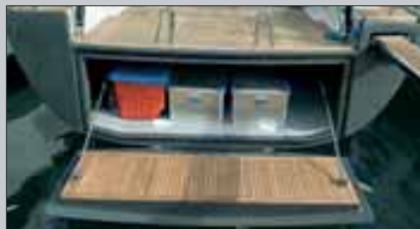
A sinistra, la poppa apribile che nasconde un ampio garage per ricoverare vele e materiali per la navigazione. A destra una immagine del pozzetto, molto ampio
