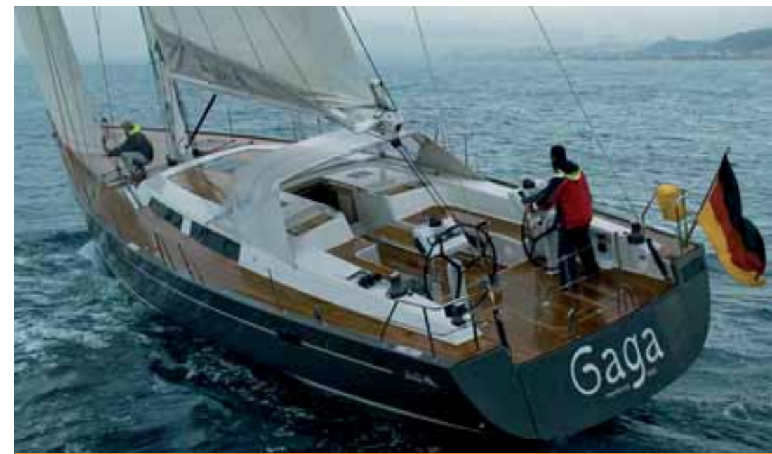
Sezioni sottili a prua, slanci quasi assenti, un baglio massimo arretrato che mantiene la sua ampiezza sino a poppa. L'Hanse 630 ha le caratteristiche per garantire navigazioni confortevoli con buone prestazioni veliche. Nelle immagini si notano la coperta pulita, il grande spazio in pozzetto e alle spalle del timoniere, le ruote in carbonio
