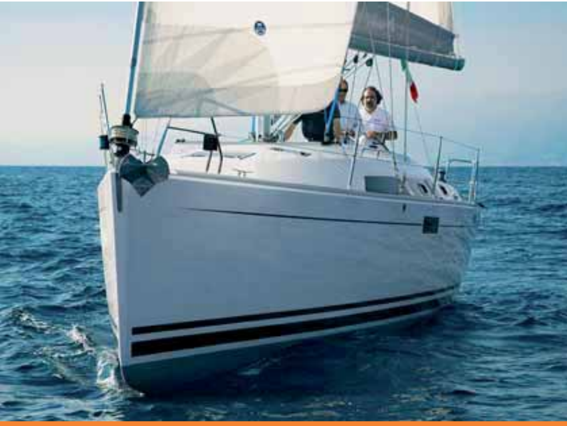
Sopra e a lato, l'ampia tuga su cui è poggiato l'albero in alluminio. Sotto, il profilo di prua quasi verticale, gli alti bordi liberi e la carena poco immersa sono gli elementi distintivi dello scafo
