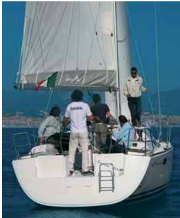
In alto, il piano velico ha uno sviluppo prevalentemente verticale, risultato ottenuto riducendo le dimensioni del triangolo di prua. A sinistra e in basso, l'ampio pozzetto. Comode risultano le panche contrapposte e la postazione riservata al timoniere
