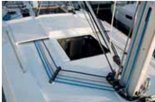
Sopra e a lato, l'ampia tuga su cui è poggiato l'albero in alluminio. Sotto, il profilo di prua quasi verticale, gli alti bordi liberi e la carena poco immersa sono gli elementi distintivi dello scafo
