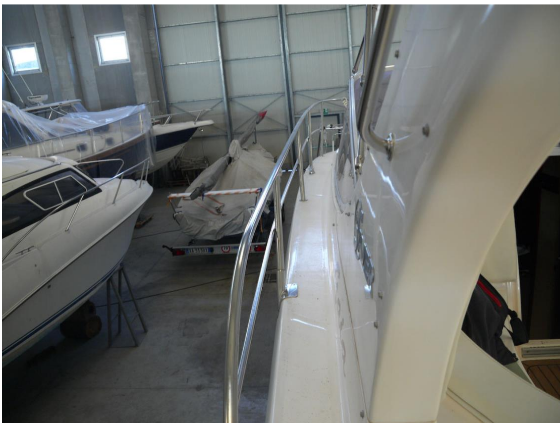
Corridoio di accesso alla zona di prua , con battagliola – lato sinistro
