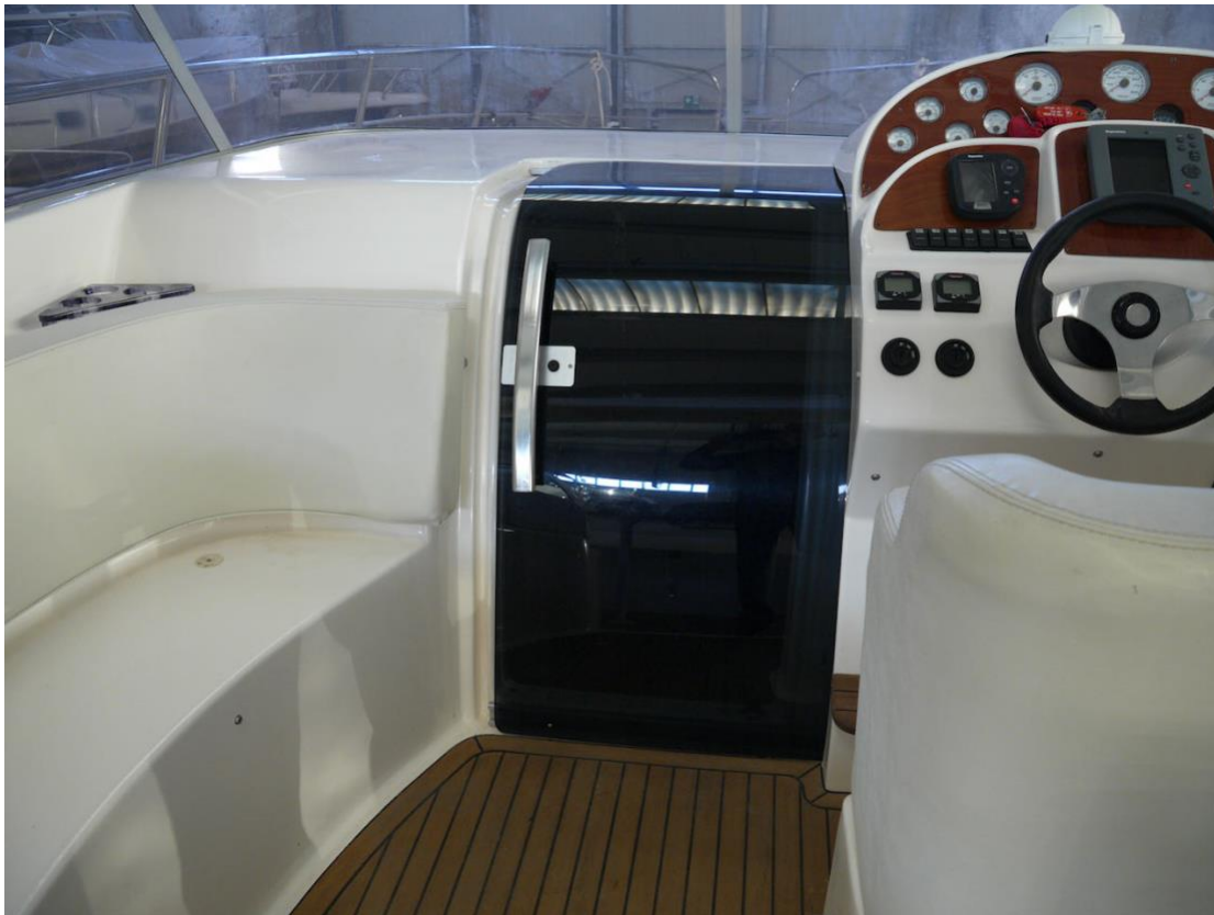
Allestimento in pozzetto : porta scorrevole di accesso alla zona alloggio
