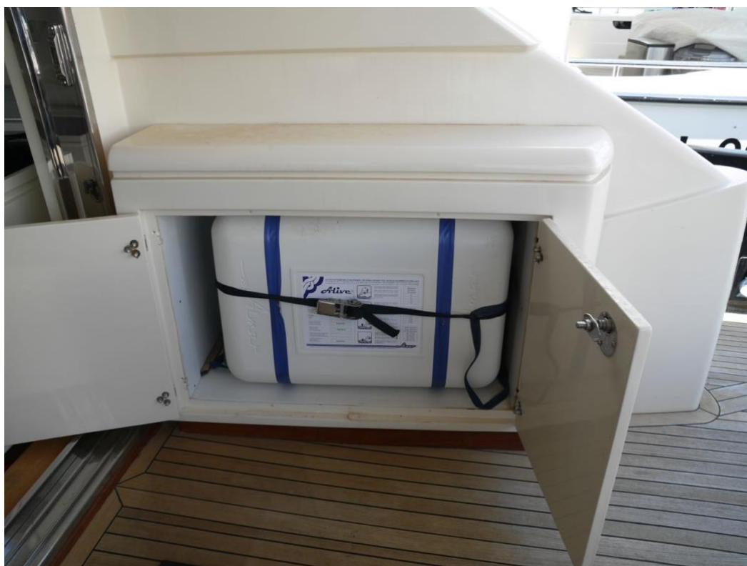
Mobile in pozzetto – contenitore zattera di salvataggio ( lato destro )
