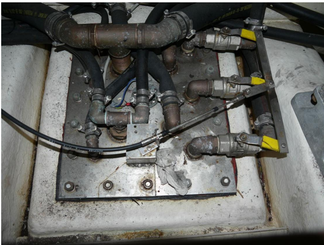
Chiusura a distanza alimentazione carburante ai motori
