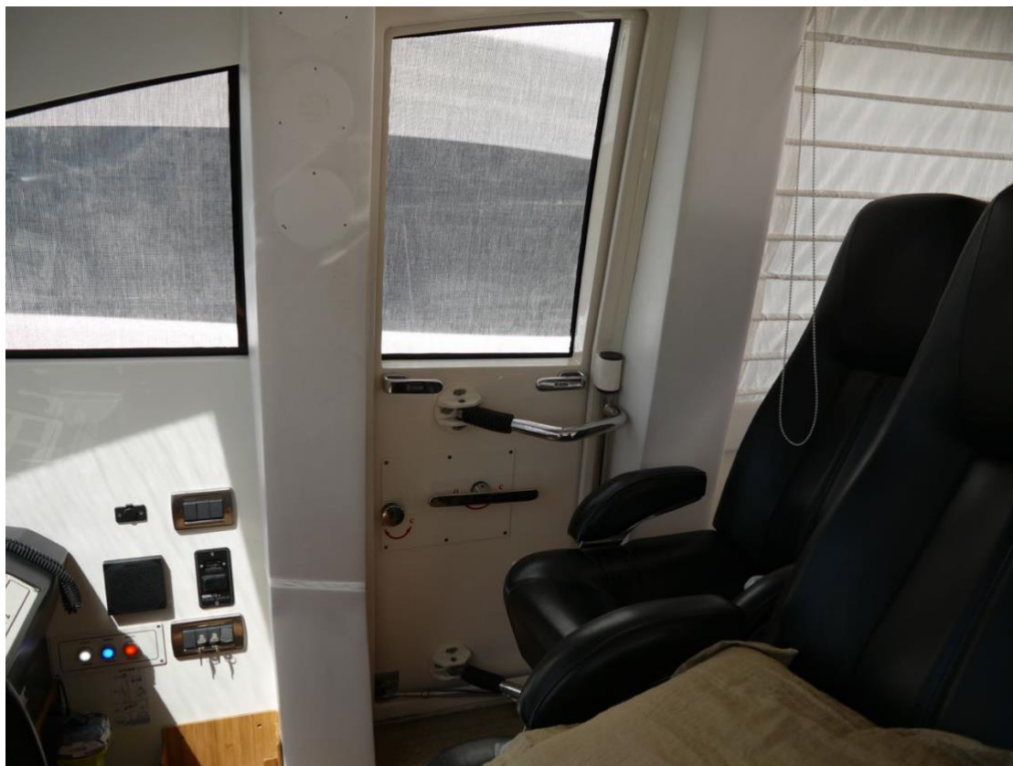
Porta stagna di accesso in coperta
