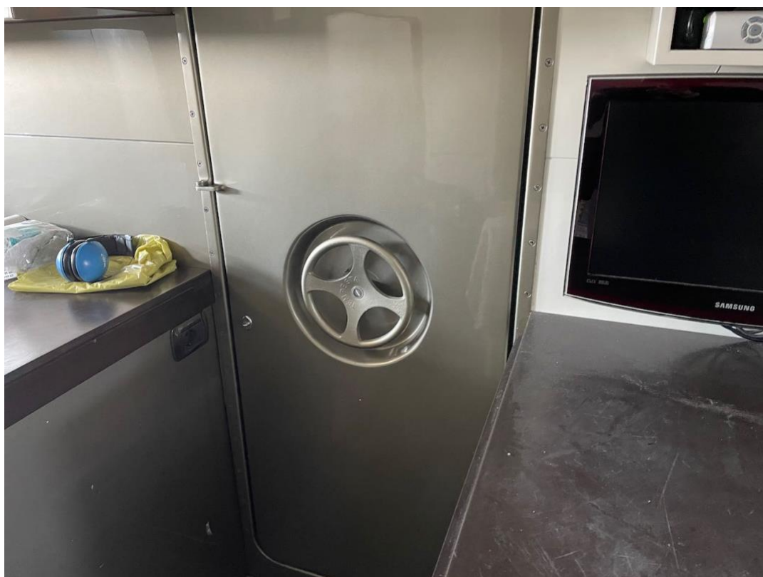
Porta stagna di accesso alla sala macchine
