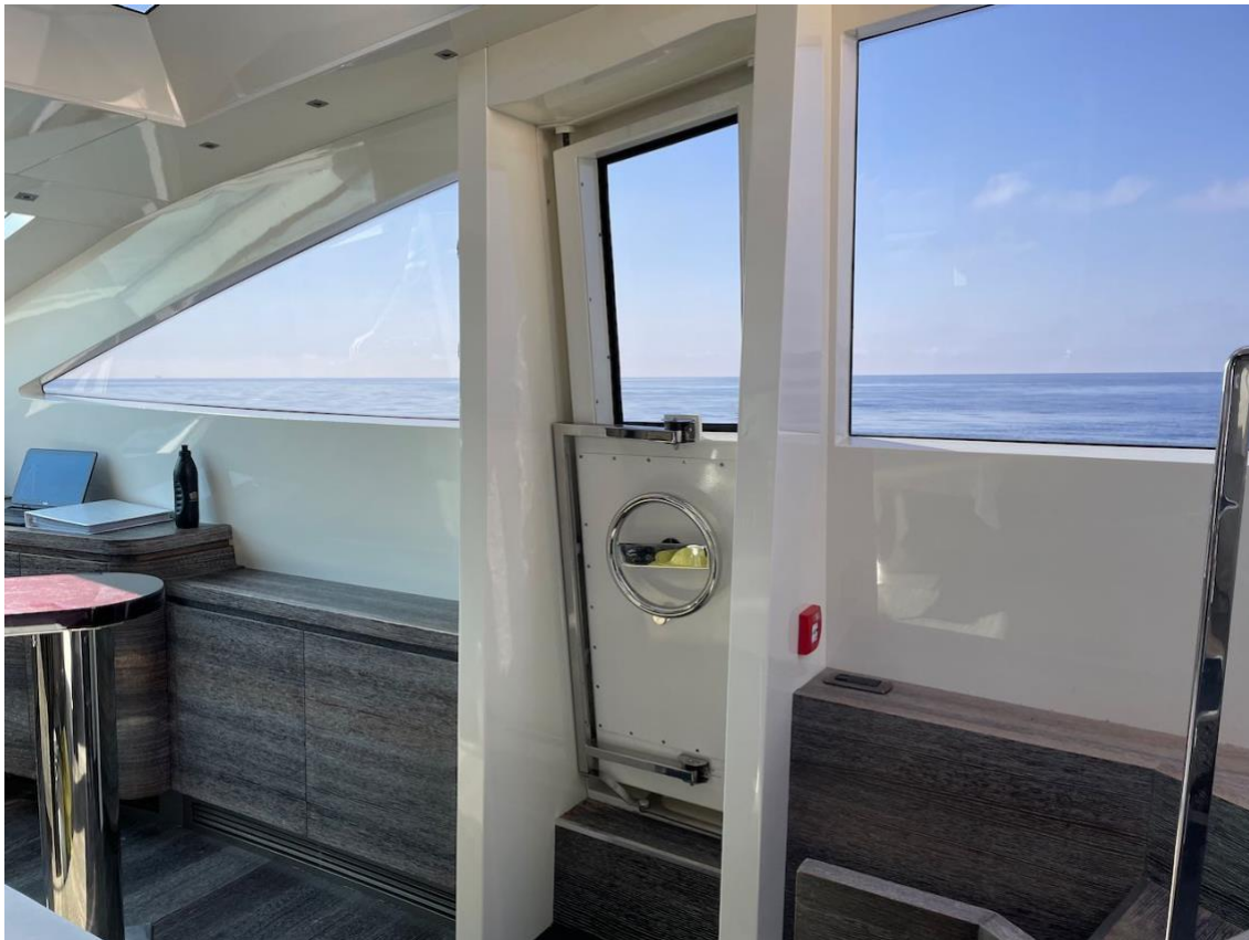
Porta stagna di accesso al camminamento esterno
