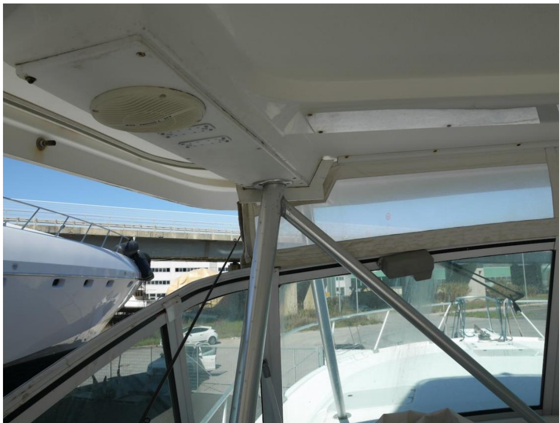
Supporti tettuccio su pozzetto – lato sinistro – impianto stereo
