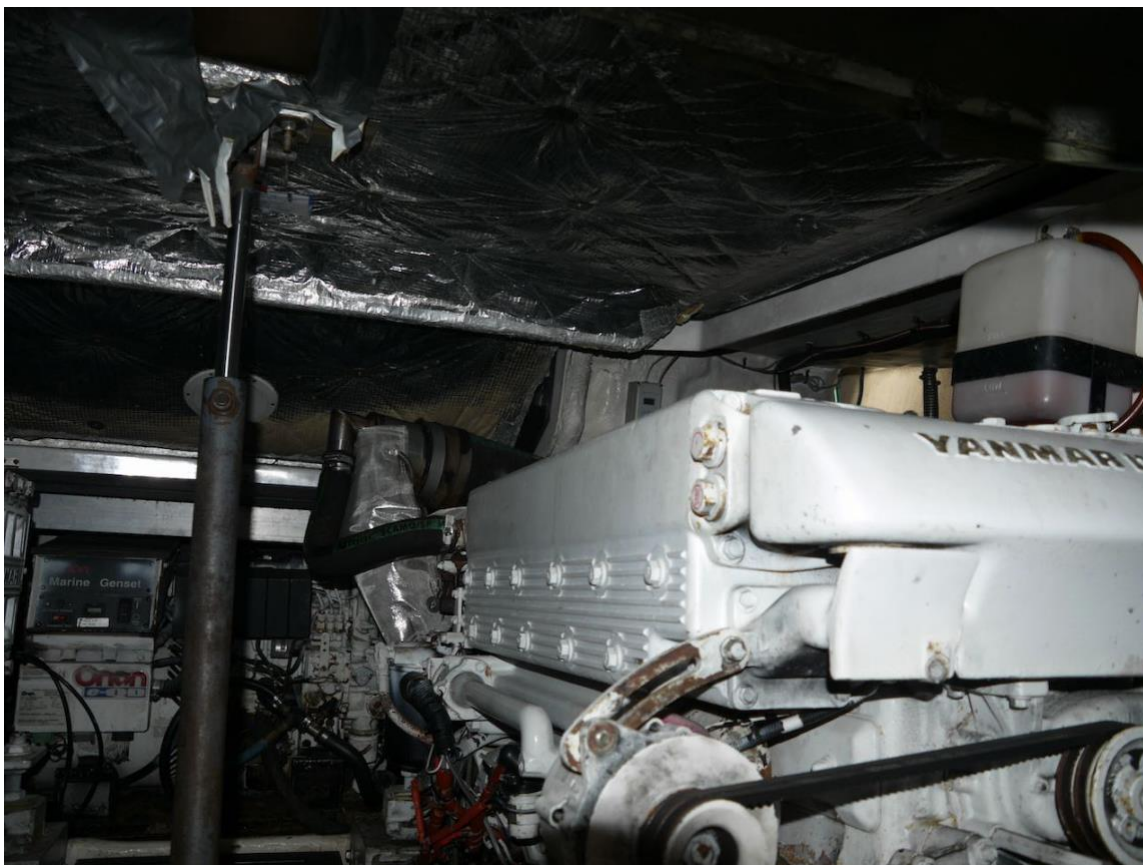
Pistone di sollevamento portellone di accesso al vano motore
