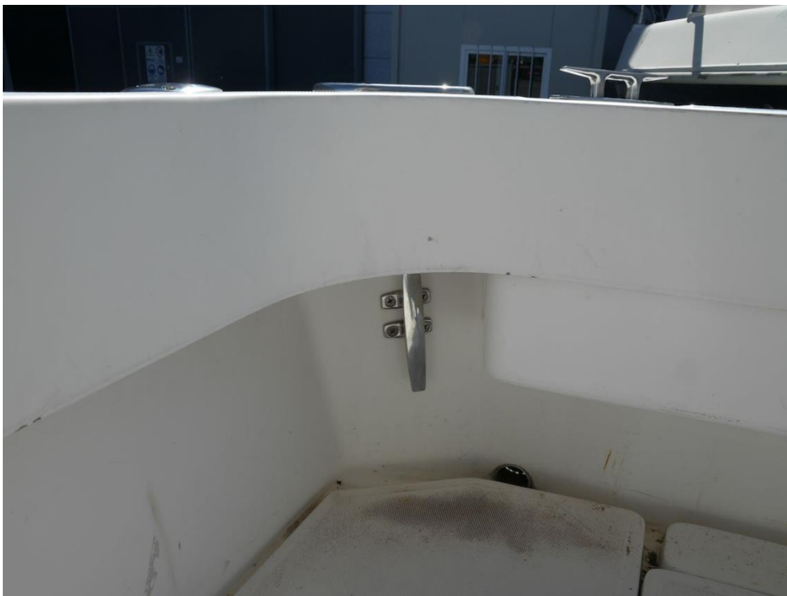
Bitta di ormeggio lato destro
