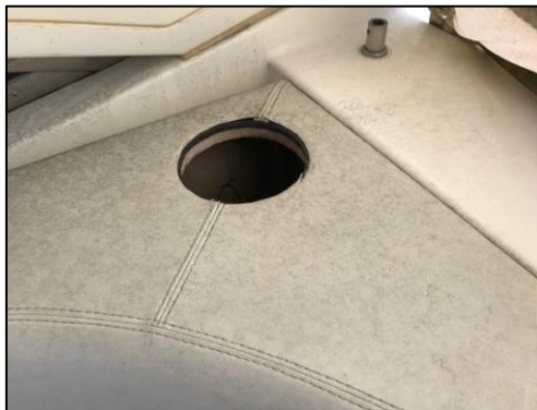
Photo 7 : manque bouche de climatisation
