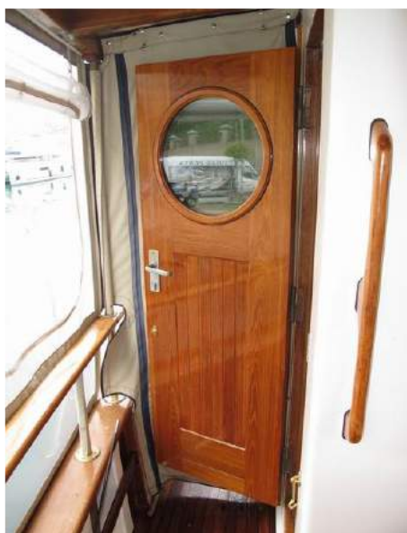
Foto 9.29 – Porta di accesso a cabina equipaggio e sala macchine
