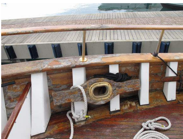
Foto 6.11 – Prua: passacavi lato di dritta
