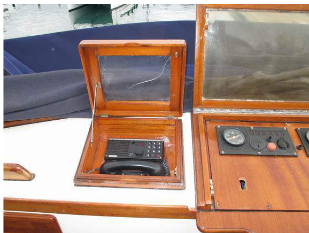
Foto 6.26 – Ponte fly: trasmettitore VHF
