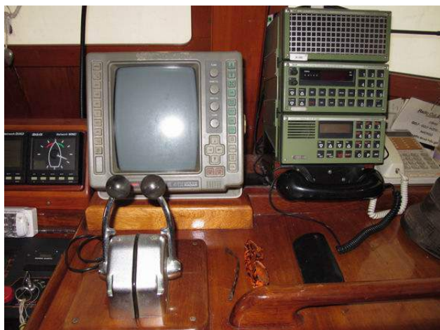
Foto 8.7 – Plancia: manette motori, radar e trasmettitore
