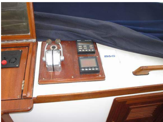
Foto 6.25 – Ponte fly: manetta motori con strumenti di controllo del pilota automatico
