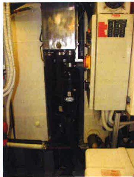
Foto 10.10 – Silenziatore motore di sinistra
