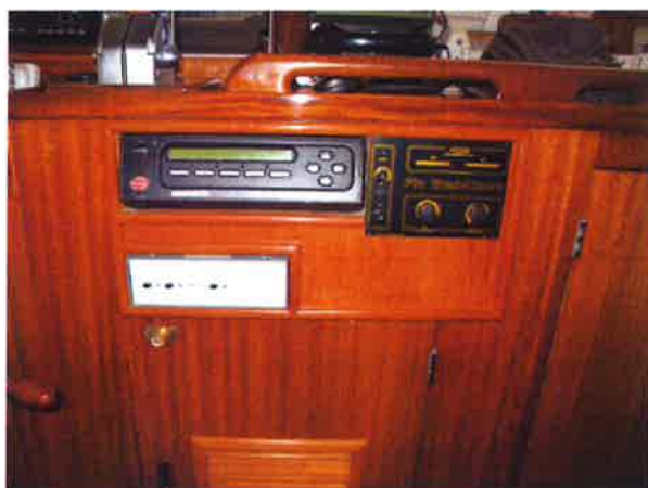
Foto 8.7 – Plancia: manette motori, radar e trasmettitore
