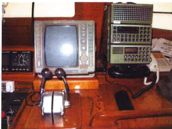
Foto 8.7 – Plancia: manette motori, radar e trasmettitore
