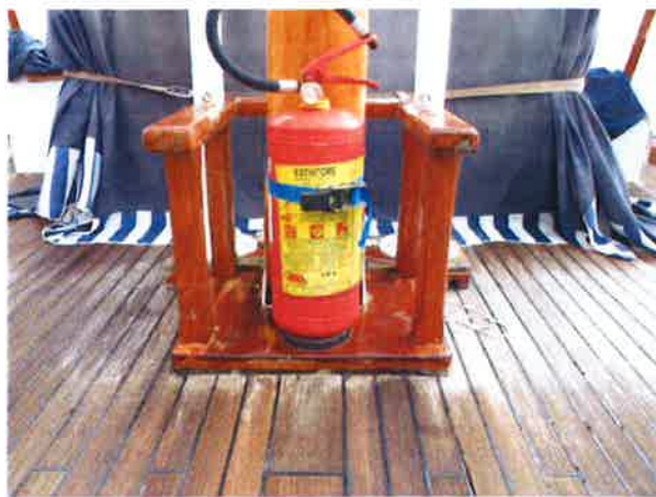
Foto 6.20 - Estintore (scaduto) alla base dell' albero porta strumenti
