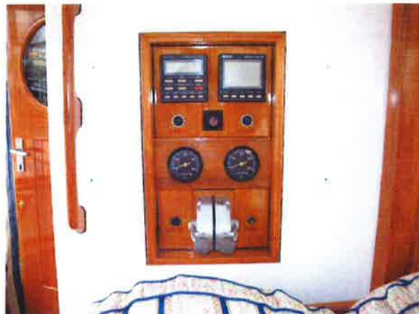
Foto 6.4 – Pozzetto: particolare ripetizione posto di manovra
