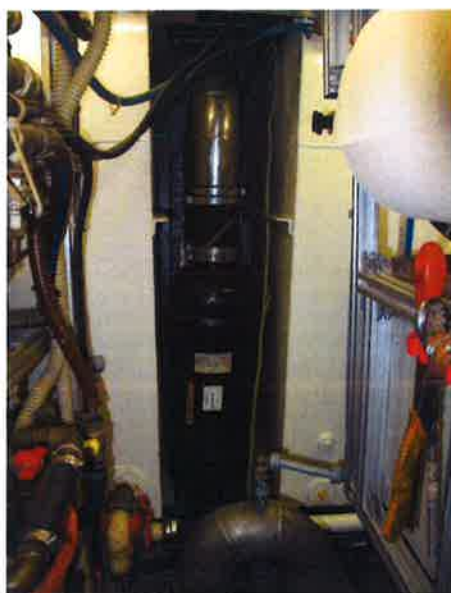
Foto 10.9 – Silenziatore motore di dritta
