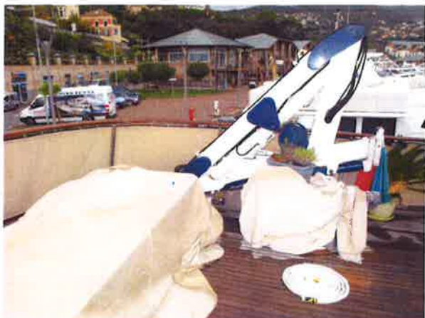
Foto 6.15 – Ponte fly: gruetta per varo tender da 2600 kg
