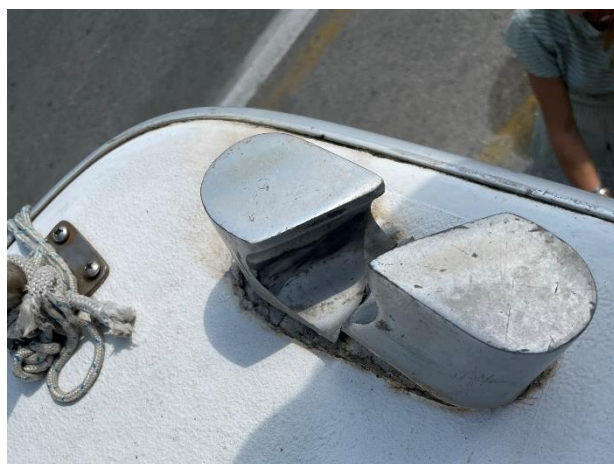
Attrezzature di coperta da sostituire
