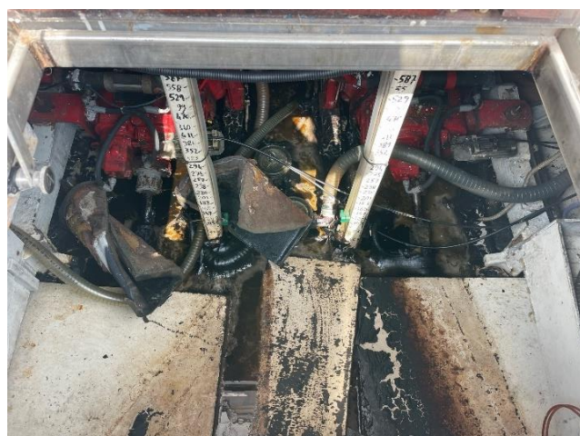
Ispezione del vano motore, presenza di liquidi oleosi in sentina
