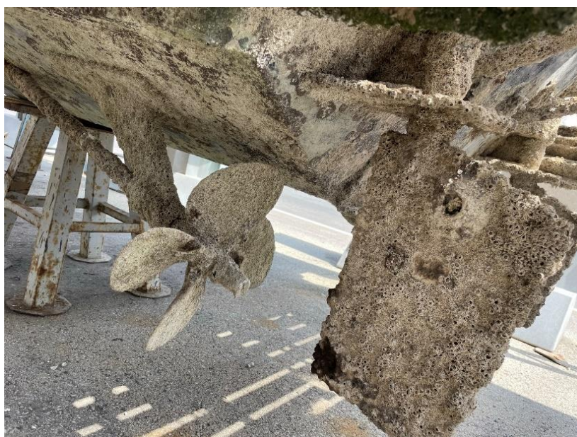
Particolare delle incrostazioni rilevate sulle attrezzature di propulsione e governo
