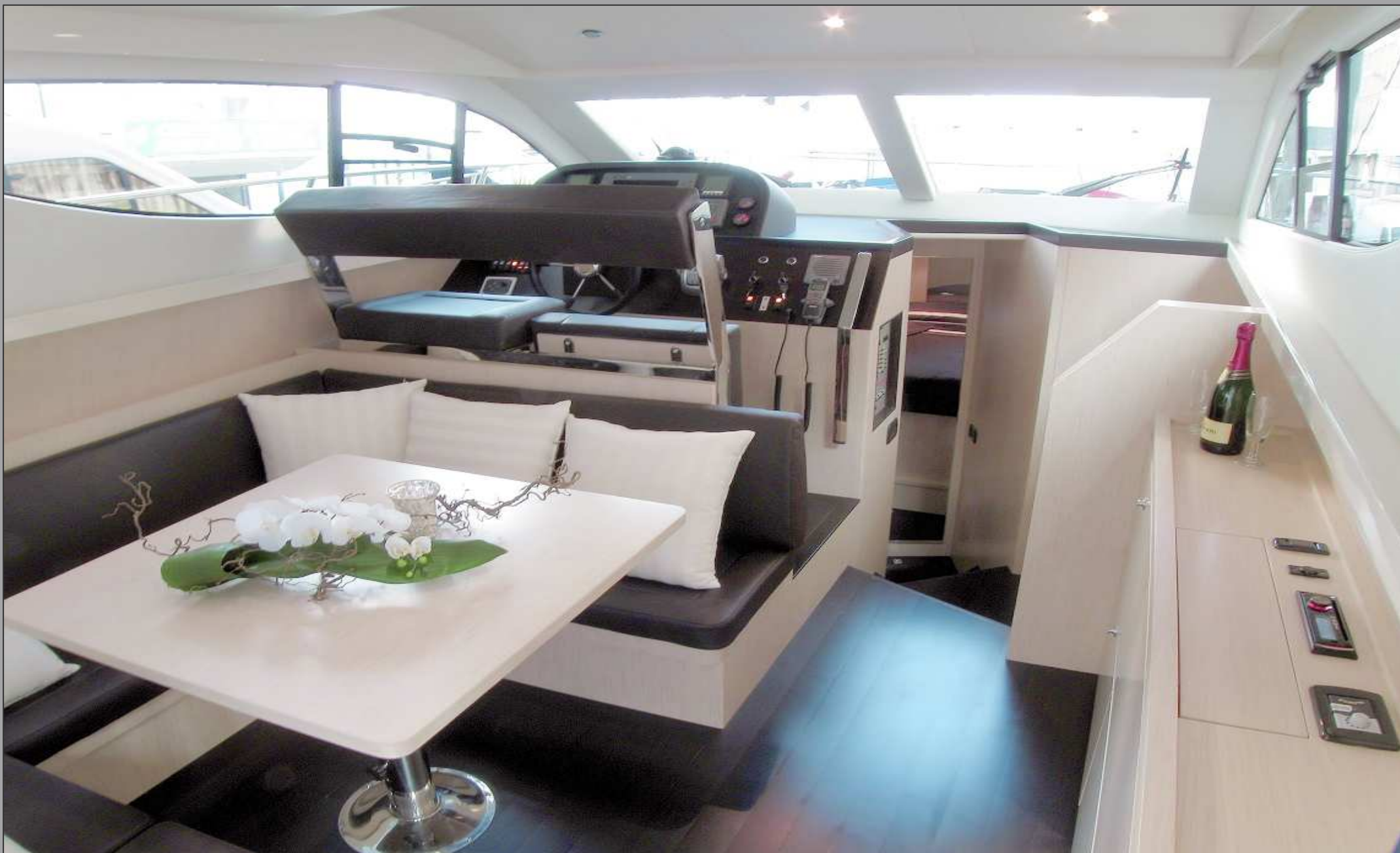
Essenze e materiali impiegati: rovere sbiancato, plancia in Wenghè, parquet in Wenghè, laccati alle pareti e plafoni su compensato marino, ecopelli con cucitura a mano, illuminazione a led
