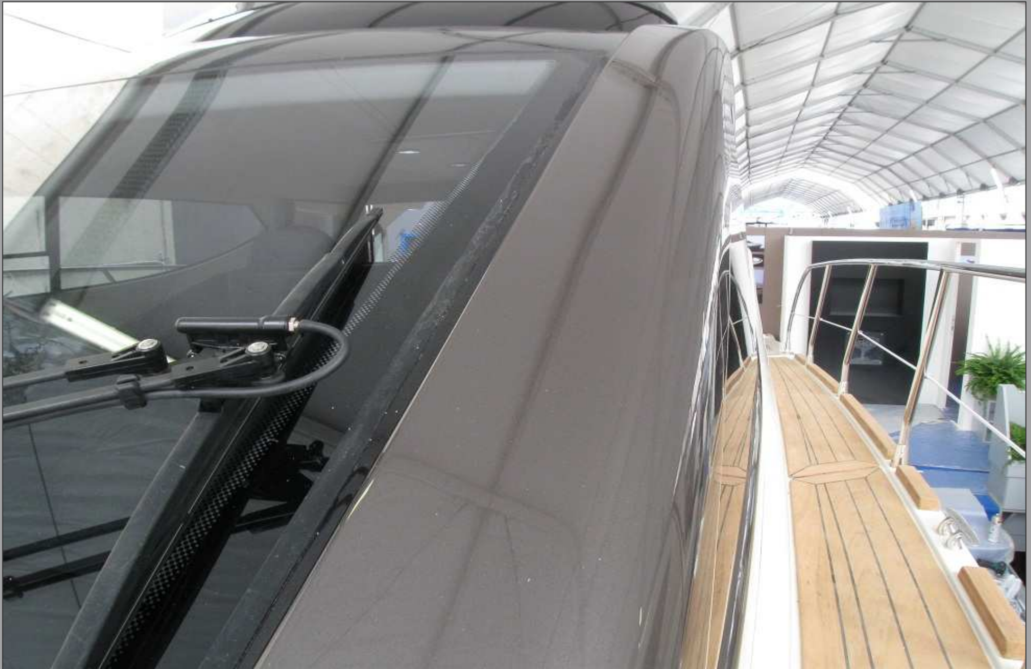
Particolare tergicristallo con pantografo e lavavetri
