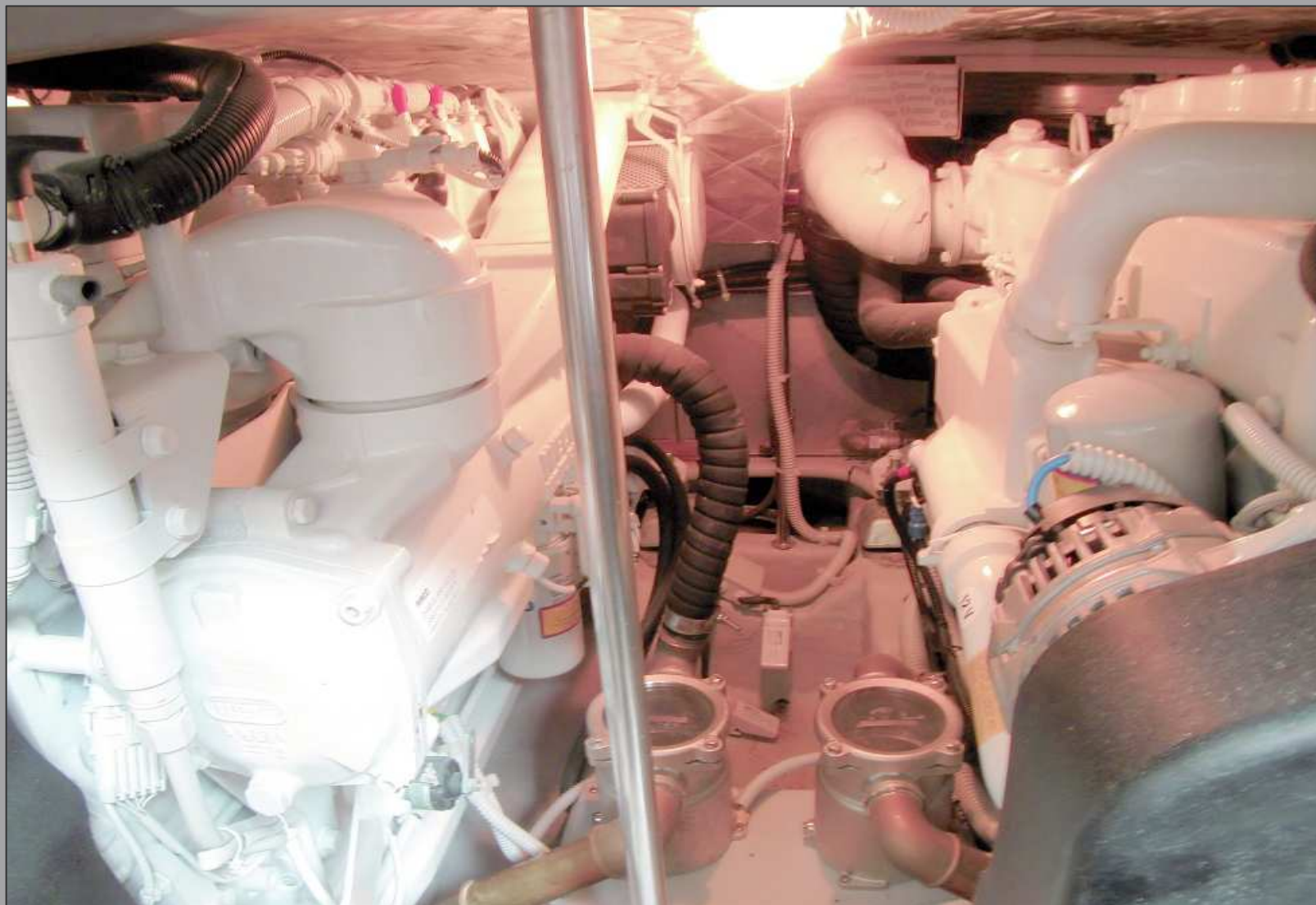
Sala macchine, motorizzazione FPT 2 x 370 hp td common rail
