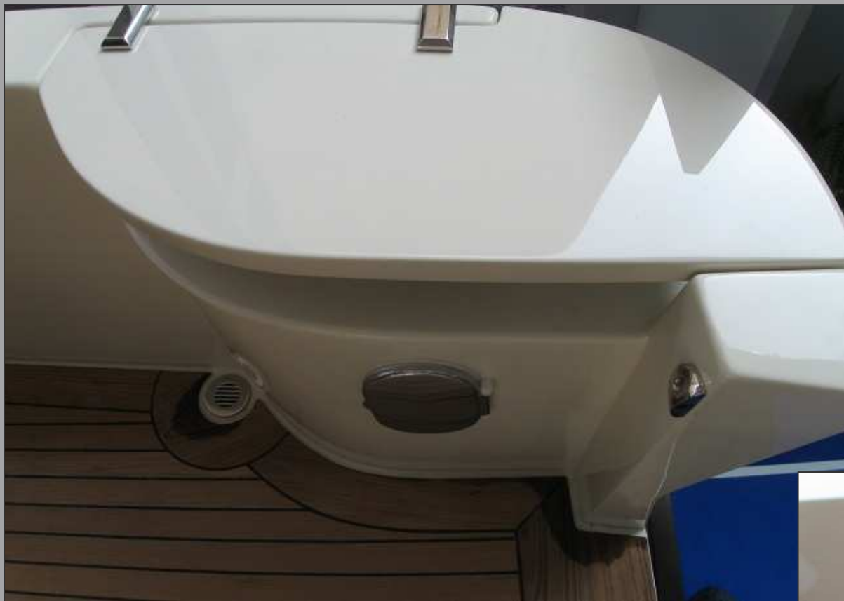
Giardinetto di dritta, particolare bitta e doccia esterna calda/fredda
