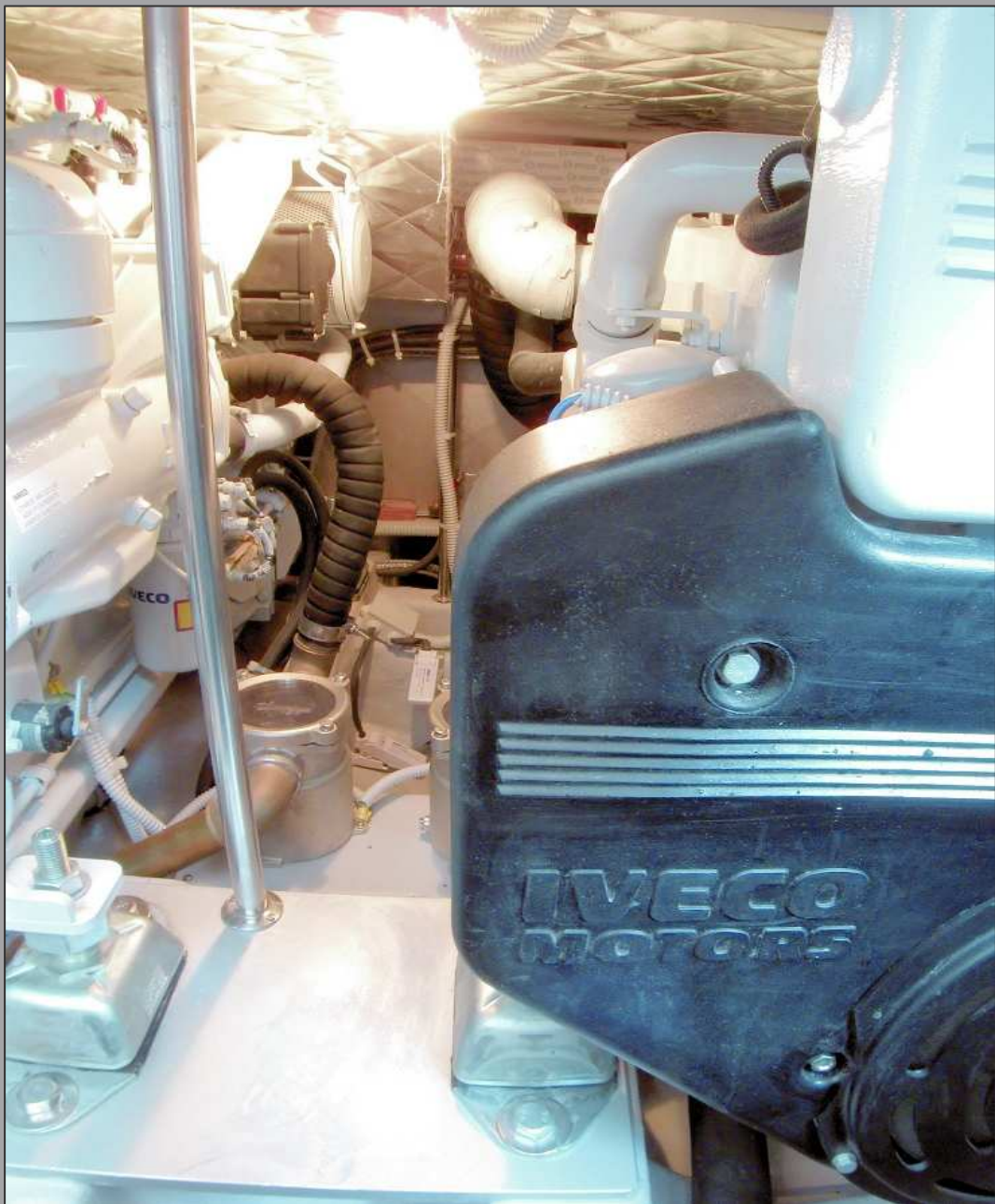
Sala macchine: particolari supporti motori, filtri acqua di mare, sensori pompe di sentina e allarmi acqua in sentina, messa a terra e coibentazione
